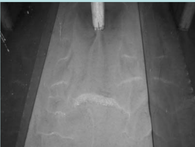
Escoamento e erosão localizada em torno do pilar vista de jusante
