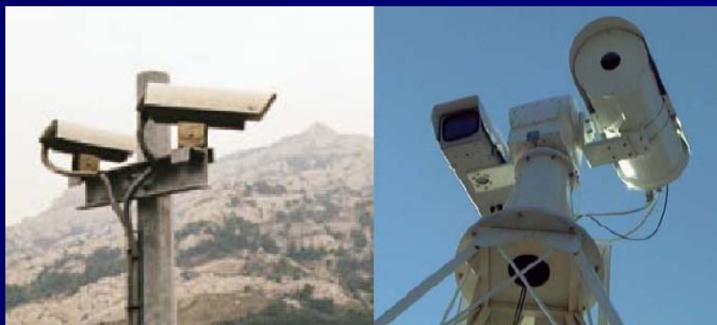
Câmaras com sistemas de detecção automática de incêndios florestais
