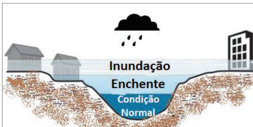
Fig. 2 - Perfil esquemático do processo de enchente e inundação. (Fonte: Dowell e Lico, 2015, p. 165).
