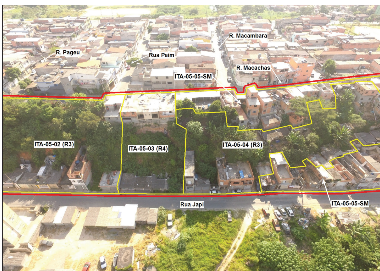
Fig. 4 - Exemplo de mapeamento de risco com a delimitação dos setores e a definição do grau de risco para uma área no município de Itapevi em imagem de drone (Fonte: IPT, 2018).
