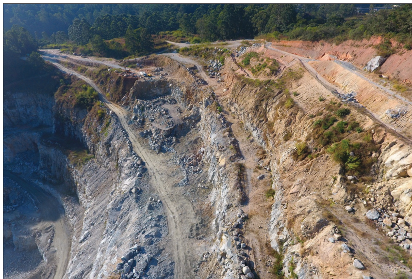
Fot. 1 - Taludes de solo em capeamento de pedreira (Fotografia de Marcelo Freitas Guimarães, tirada a 25/10/2017).
