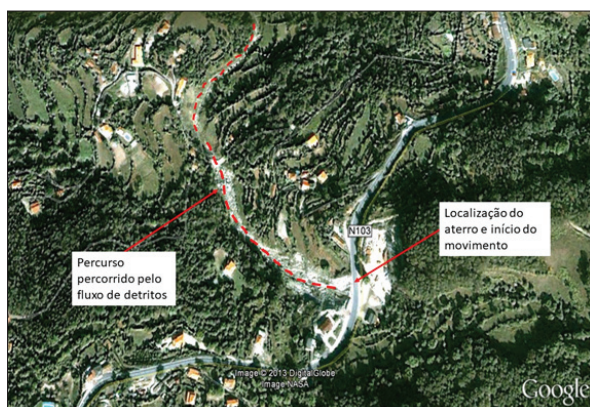
Fig. 9 - Esboço da área afetada, com a localização do aterro e delimitação de parte do percurso percorridos pelos detritos deslocados (Fonte: Google Earth).
