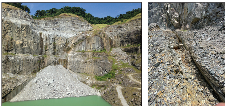
Fot. 6 - Zonas cisalhadas no maciço rochoso (Fotografia de Jehovah Nogueira Jr., tirada a 11/02/2019).
