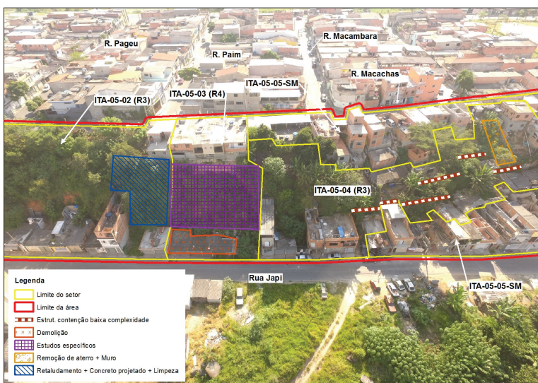
Fig. 5 - Exemplo de mapeamento de risco com a indicação de intervenções estruturais, para uma área no município de Itapevi (Fonte: IPT, 2018).
