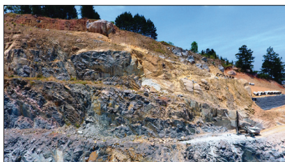
Fot. 8 - Bolsões de solo e rocha alterada no maciço rochoso (Fotografia de Jehovah Nogueira Jr., tirada a 12/03/2022).
