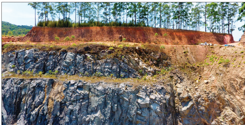
Fot. 9 - Maciço rochoso extremamente fraturado (Fotografia de Marcelo Freitas Guimarães, tirada a 25/10/2017).
