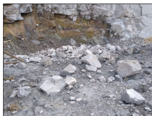
Fot. 8 - Bolsões de solo e rocha alterada no maciço rochoso (Fotografia de Jehovah Nogueira Jr., tirada a 12/03/2022).
