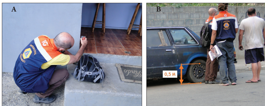
Fot. 1 - Trabalho de campo na área de estudo para coleta de informações de profundidade da lâmina d'água ( NAt ) atingida pelas águas pluviais em fenômenos de enxurrada: A) medida com trena métrica na parede com marca d'água ou informação de moradores; B) medida com trena métrica (0,5 metros) no pneu do carro quebrado estacionado há muito tempo no local de enxurrada com evidências de restos de vegetação e lixo trazidos pela enxurrada (Fotografia de Paulo Leal / Acervo IPA, tirada em 28/03/2022).
