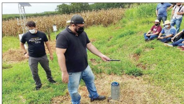
Fot. 2 - Técnico simulando o funcionamento de aparelho instalado no poço piezométrico
