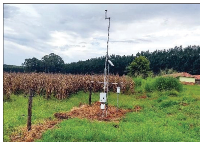
Fot. 3 - Estação Meteorológica Automática da Escola Técnica Estadual
